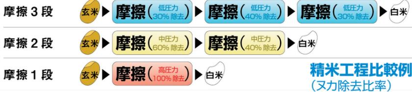
「ミルコンボ・摩擦3段タイプ」は、摩擦式の精米室を3室備えており、それぞれの精米室を順に通過する際に又力が削られます。3室に分散させることで、従来の1室あるいは2室タイプの精米機に比べ、低い圧力でやさしく精米できます。削りすぎることなく又力を取り除くことで、粒感のしっかりした米飯に仕上がります。また、残留米除去機能を装備し、生産ロットの切替時間が3分と迅速に切替えできます。最低30キログラムからの小ロット精米が可能で、多品種少量生産にも対応します。
