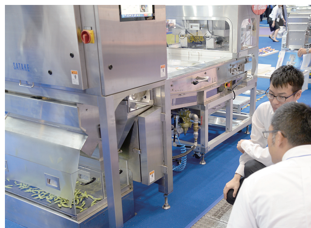
多用途ベルト式光選別機「BELTUZA XeNO」で生枝豆の選別を実演
