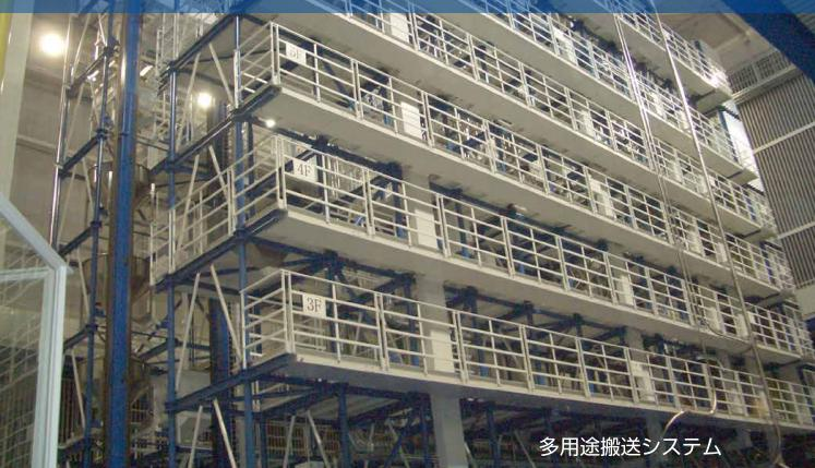
従来の精米工場は、各機械を平面設置し昇降機やコンベアにより穀物自体を搬送(移動)させていました。多用途搬送システムでは、各機械を多用途ラック内に立体配置し、1トン以下の穀物が入った運搬ボックスを目的の場所に自動搬送機で搬送し、異品種混入・異物混入(コンタミネーション)を防止するとともに、穀物へダメージを与えないものとしています。
