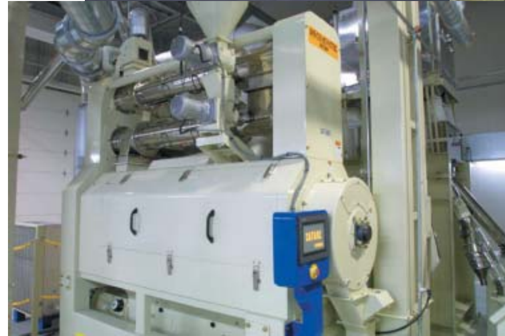
精米工場に設置されている無洗米製造装置「ネオ・テイスティ・ホワイト・プロセス」。
