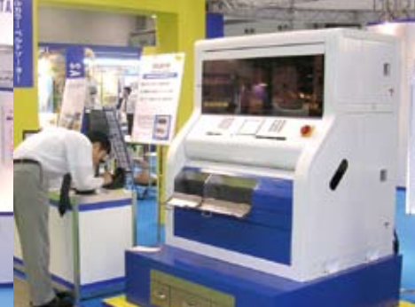
胴割選別機 業界初の玄米・白米中の胴割粒を選別できる光選別機です。機内残留がありませんので、コンタミの心配もありません。
