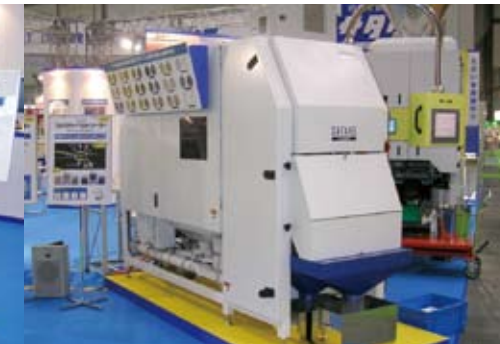
フルカラーベルトソーター(光選別機) フルカラー CCD カメラに加え NIR カメラを搭載し、原料と同色の混入異物も選別が可能になりました。
