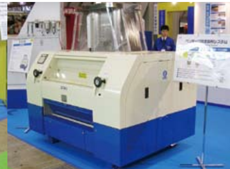
ローラーミル(製粉機) 衛生面・機能面で進化した新型の製粉機です。メンテナンス時間も短縮し、小麦以外の穀物の粉碎に対応可能です。
