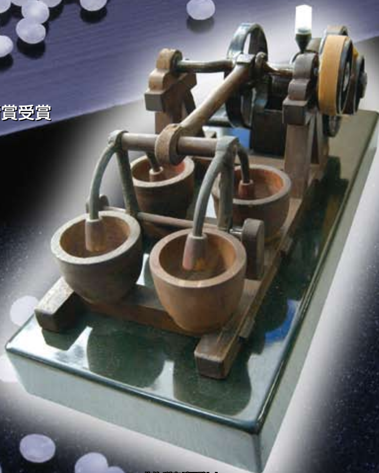
佐竹 利市が開発した 日本初の動力式精米機の復元模型
