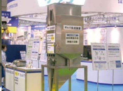
ギャバ米製造システム 機能性米のひとつとして、玄米から効率的にギャバを生成させ、胚乳に移行させた後、精米・無洗米加工する装置です。
