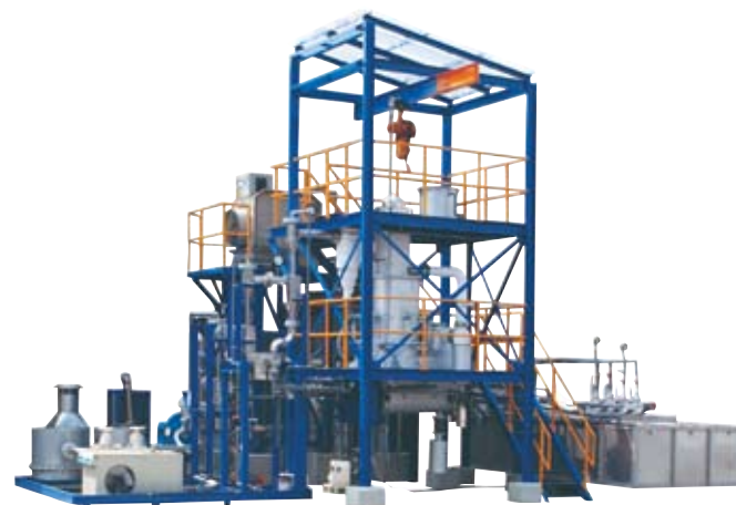
写真：バイオマスガス化発電システム
