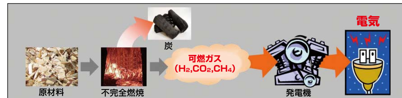
図11：バイオマスガス化発電イメージフロー
