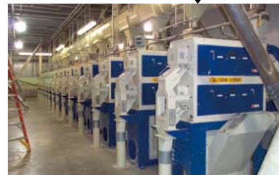
研米機 (KB80GM) で外皮を剥ぎ取り、エタノールの原料となる胚乳部を取り出します。
