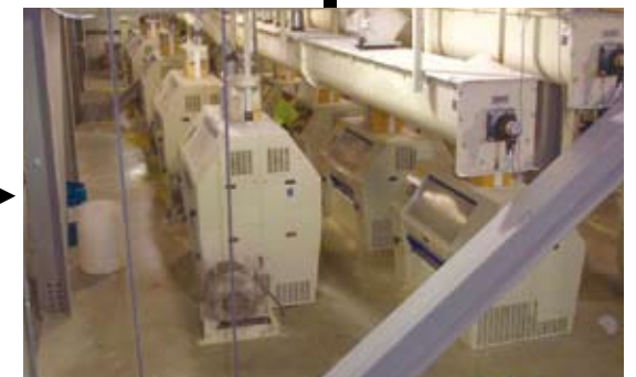
外皮を剥いで取り出した胚乳部のみをローラーミル (SRM125B, SRMD125A) で粉碎し、効率よくエタノールを製造するための原料にします。
