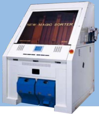
図3 試験機 A (マジックソーター) の外観
