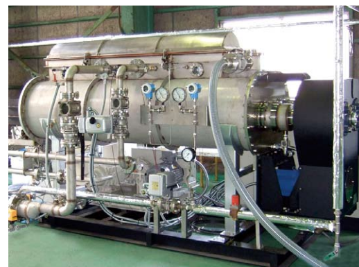
連続式乾燥処理装置（2号機）
