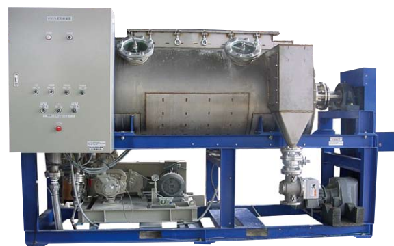
バッチ式乾燥処理装置（1号機）
