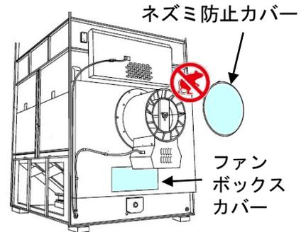
ファンボックスのカバーを取外し、残留穀物を掃除してください。掃除後はネズミ防止カバーを取付けて下さい。
