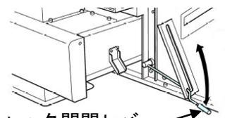
下部シャッター開閉レバーを開き、残留穀物を機械の下に落とし、落ちた穀物を掃除します。
