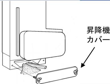
昇降機カバーを取外し、残留穀物を取り除きます。
