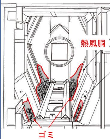
フロントカバー・バーナー・ガード・遠赤放射体を取外し、風胴内を掃除します。
