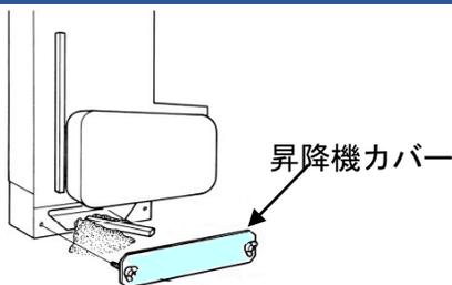
昇降機カバーを取外し、残留穀物を取り除きます。
