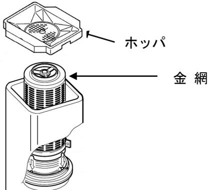
タンクを倒し、ホツパを外します。カナアミを左に回しながら持ち上げると外れます。外したカナアミを掃除します。
