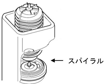
スパイラルを持ち上げ、清掃します。掃除後、軸にしっかりはめ込み、組み付けます。
