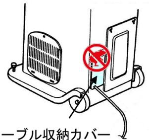
電源ケーブル収納カバーを取外し、電源ケーブル・アースを収納します。
