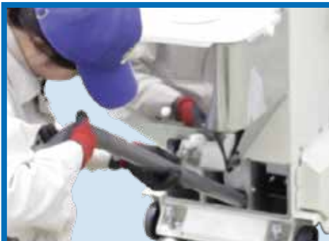
カバーを外し、昇降機下部に残っているホコリや穀粒を掃除します。
