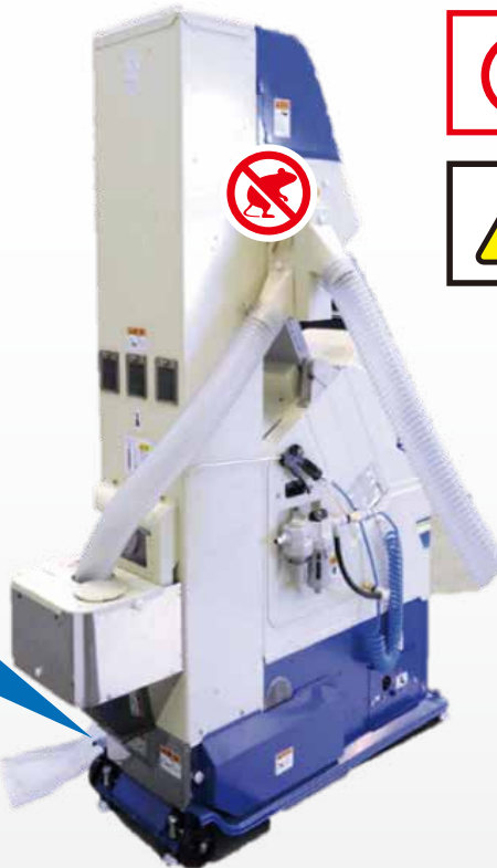
カバーを外し、昇降機下部に残っているホコリや穀粒を掃除します。
