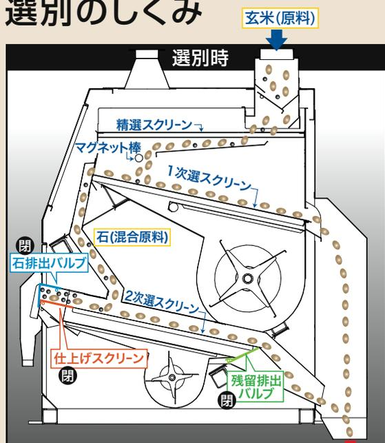
供給された原料は、1次選・2次選スクリーン上で石が選別され、混合原料は仕上げスクリーンで石が濃縮され、石排出バルブ側に集まります。
