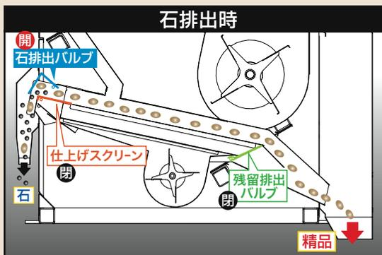
石排出バルブは、設定された間隔時間で開き、石排出口に集まった石が機外に排出されます。
