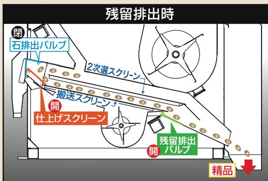
石排出後に残った原料は仕上げスクリーンが選別側から搬送側に切り替わり、精品排出ホッパ側に排出されます。(BRのみ)
