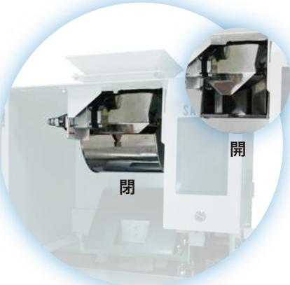
1ゲート方式で構造をシンプル化。生産終了時の残量を減らし、原料ロス低減と清掃作業の効率化を実現しました。
