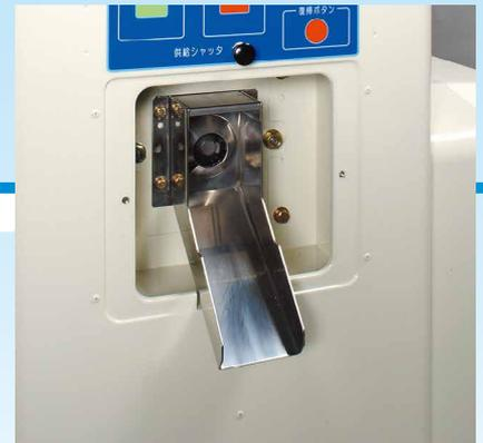
前面の操作パネルを外すと、搗精部の点検・清掃が簡単にできます。
