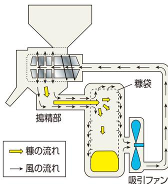
強力ファンによる噴風・吸引方式により米温の上昇を抑え、糠切れのよいきれいなお米に仕上げます。
