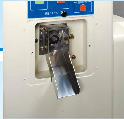
前面の操作パネルを外すと、搗精部の点検・清掃が簡単にできます。
