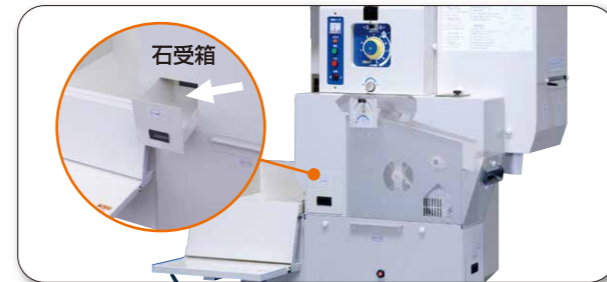
選別された石は、専用の石受箱へ。レバー1本で簡単に排出。
